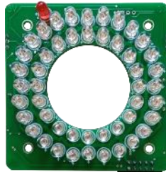
Рисунок 20 – Плата подсветки с индикатором питания
