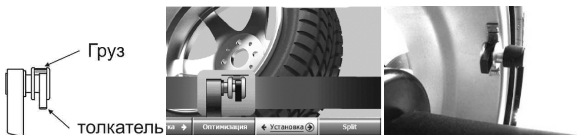
Рисунок 5.13 – Установка груза линейкой
