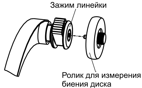
Рисунок 7.5 – Ролик для измерения биений
