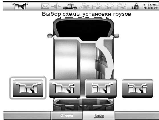
Рисунок 6.4 – Схемы установки грузов
