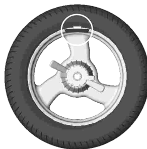
Рисунок 6.6 - Груз установлен в «12 часов»
