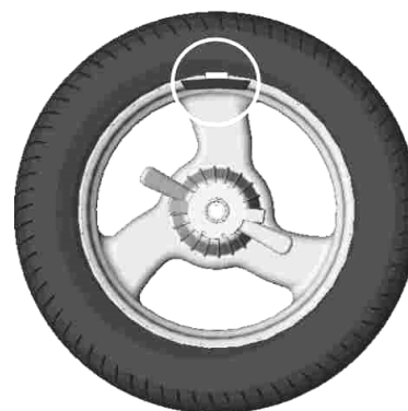
а – экран при установке груза со скобой б - груз установлен в положение «12 часов»
