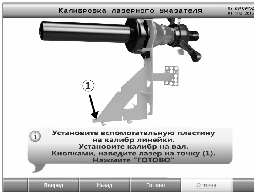
Рисунок 8.7 – Окно калибровки лазерного указателя
